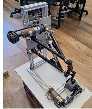
Figura 1. Montagem completa da suspensão ativa.
